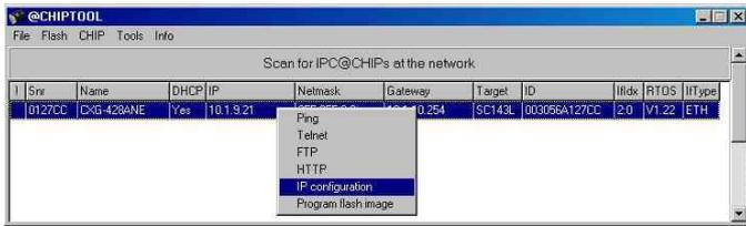
Настройка IP-адреса проводится в программе «@CHIPTOOL» нажатием правой кнопки мыши на контроллере в списке и выбором «IP Configuration»
