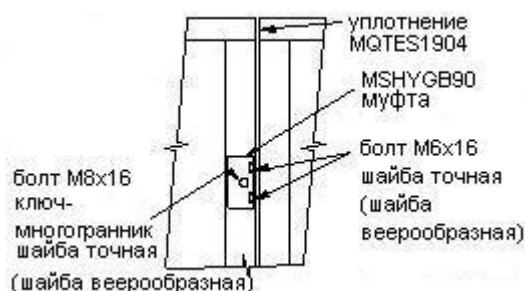
Соединение камер: В – отличающиеся размеры камер
